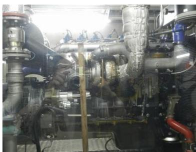
ガスエンジン (ガス化ユニットで発生したガスを使ってエンジンを動かし、電気と熱を発生させる)
